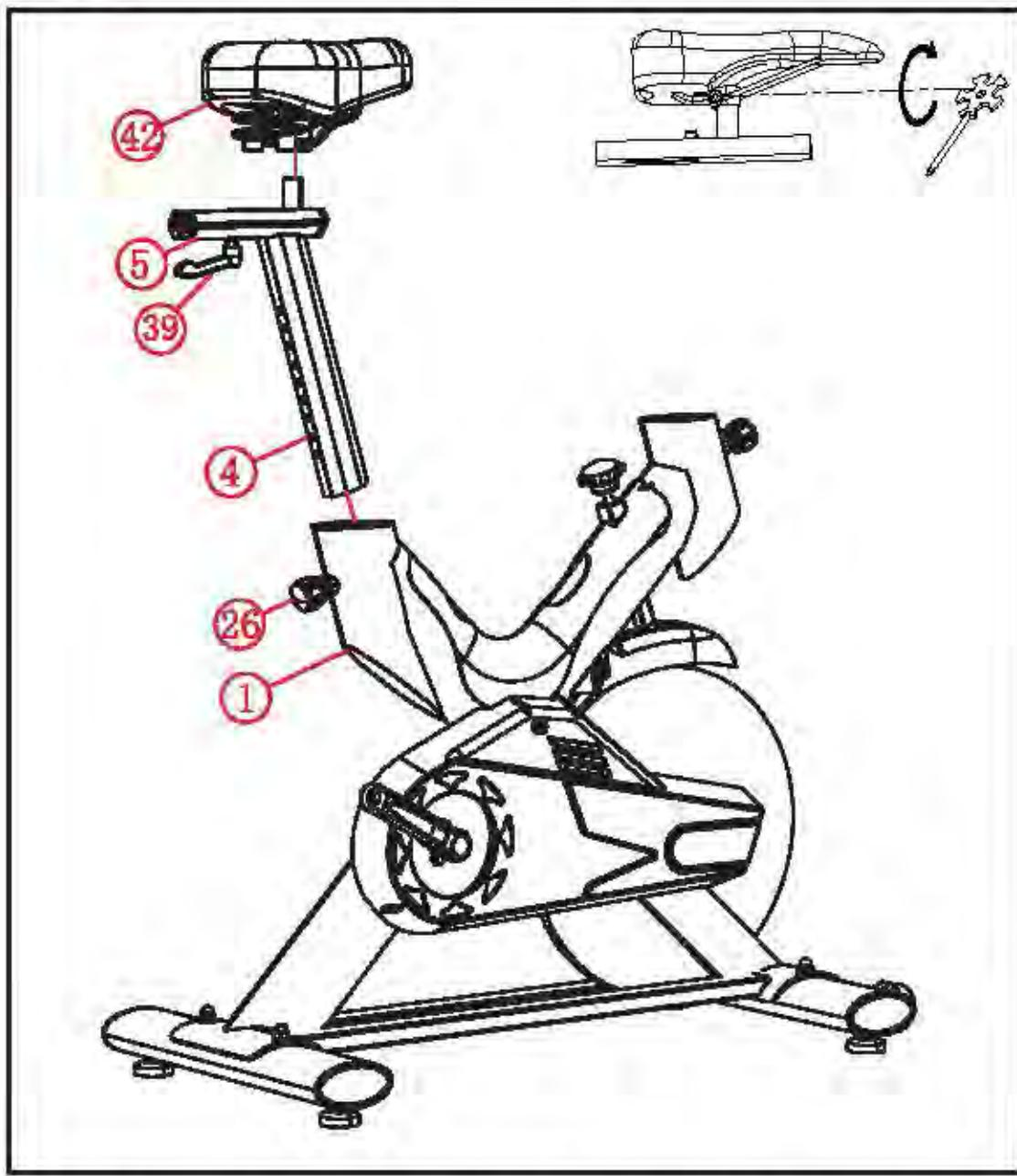
Сначала открутите регулировочную ручку (26) и снимите её с тренажёра. Затем вставьте держатель сиденья (4) в корпус (1) тренажёра, отрегулируйте его положение и зафиксируйте, заново установив ручку (26). При этом ручка должна попасть в одно из отверстий на держателе, в противном случае, конструкция не будет полностью зафиксирована.
