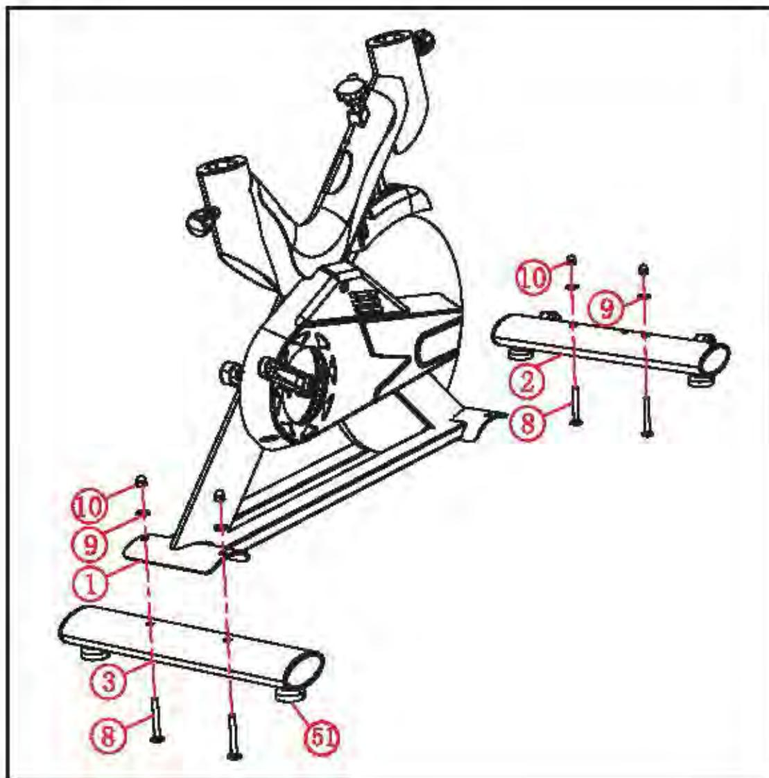
Прикрепите передний (2) и задний (3) стабилизаторы к корпусу (1) при помощи четырёх комплектов крепежей – каретных болтов (8), плоских шайб (9) и глухих гаек (10).
