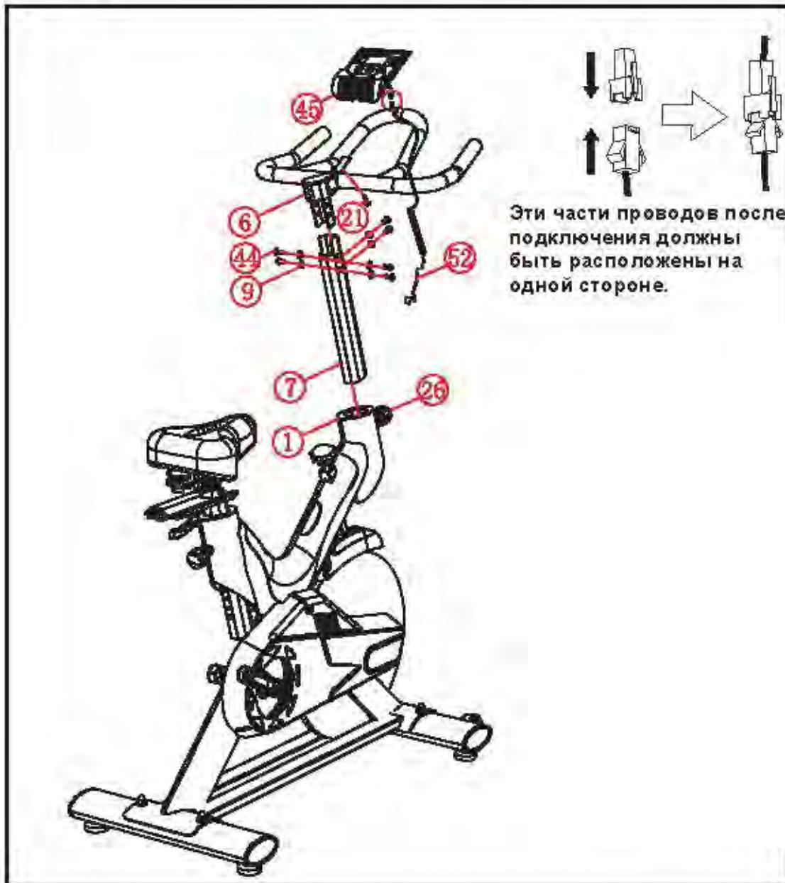
Открутите регулировочную ручку (26), вставьте опорную стойку (7) в корпус (1) тренажёра и после этого заново закрутите ручку, чтобы зафиксировать конструкцию.
