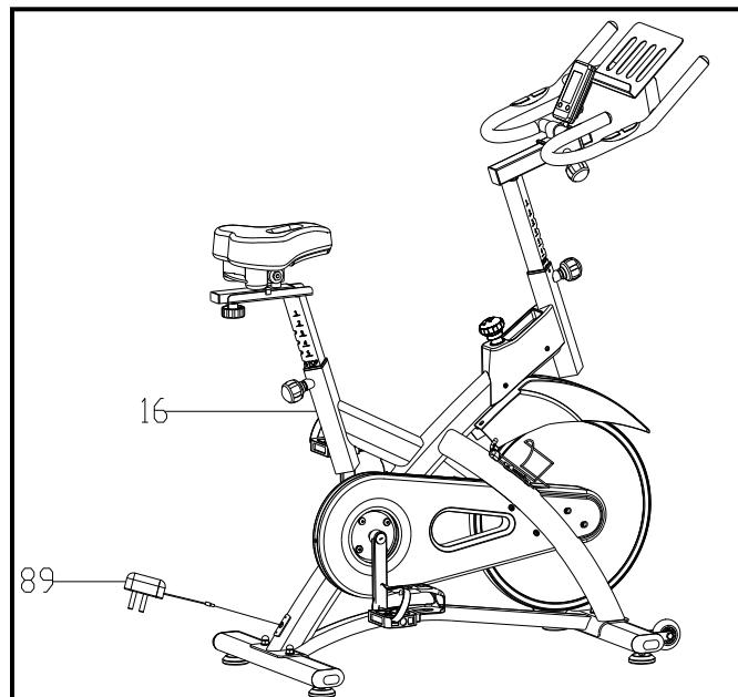
Вставьте блок питания (89) в разъем на задней панели основной рамы (16).
