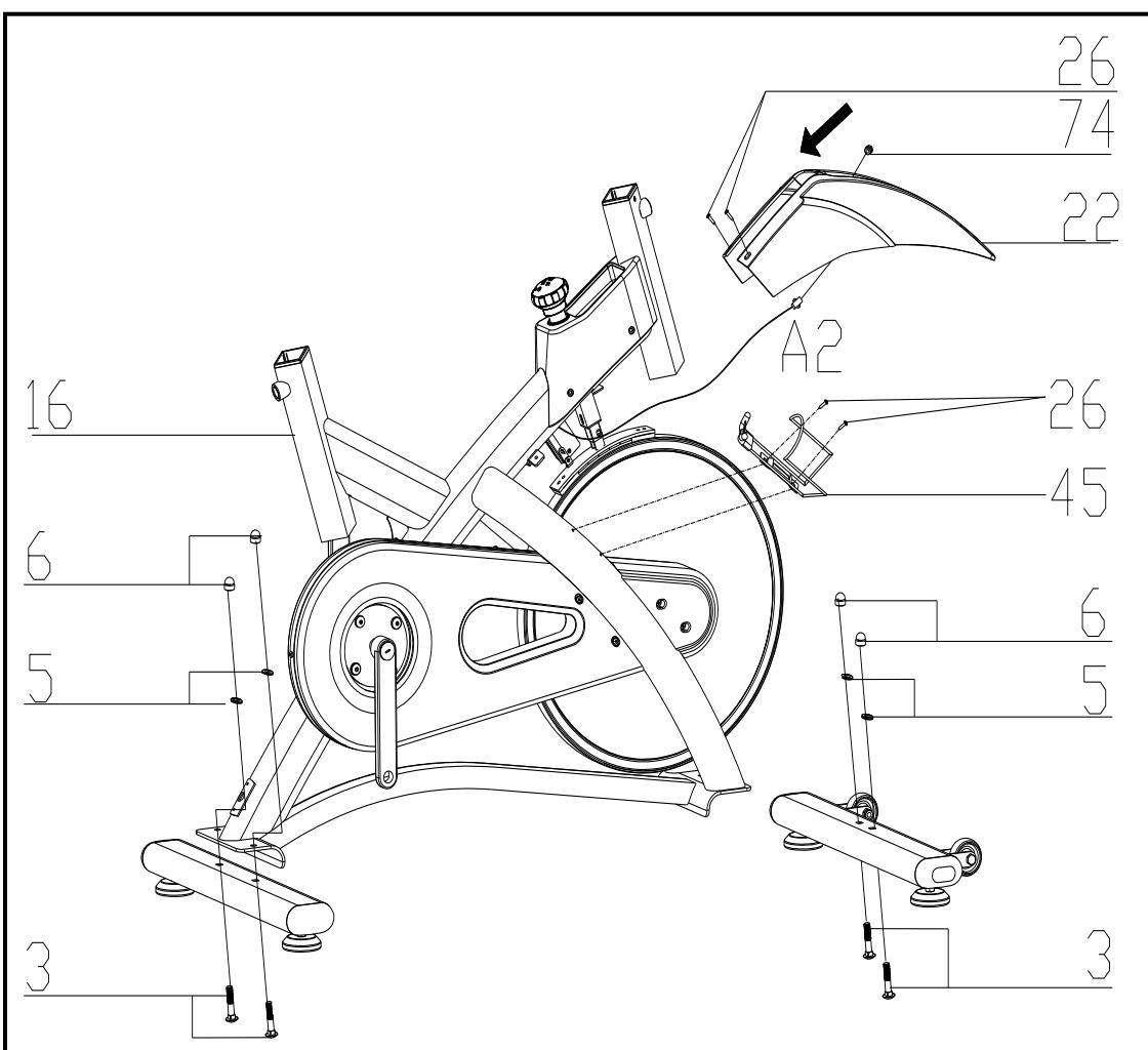
Установите передний стабилизатор (15) на основную раму (16) и закрепите с помощью двух плоских шайб Ø8 (5), гайки M8 (6) и болта (3).
