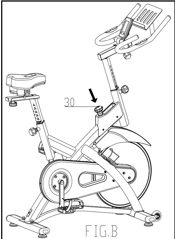
Та же ручка, которая позволяет регулировать натяжение спин-байка, также выполняет функцию аварийного торможения. Используйте данную функцию в любой ситуации, когда необходимо внезапно сойти с тренажера и/или остановить маховик. Чтобы использовать функцию аварийного торможения, сильно нажмите на ручку управления аварийным тормозом и натяжением (#30).
