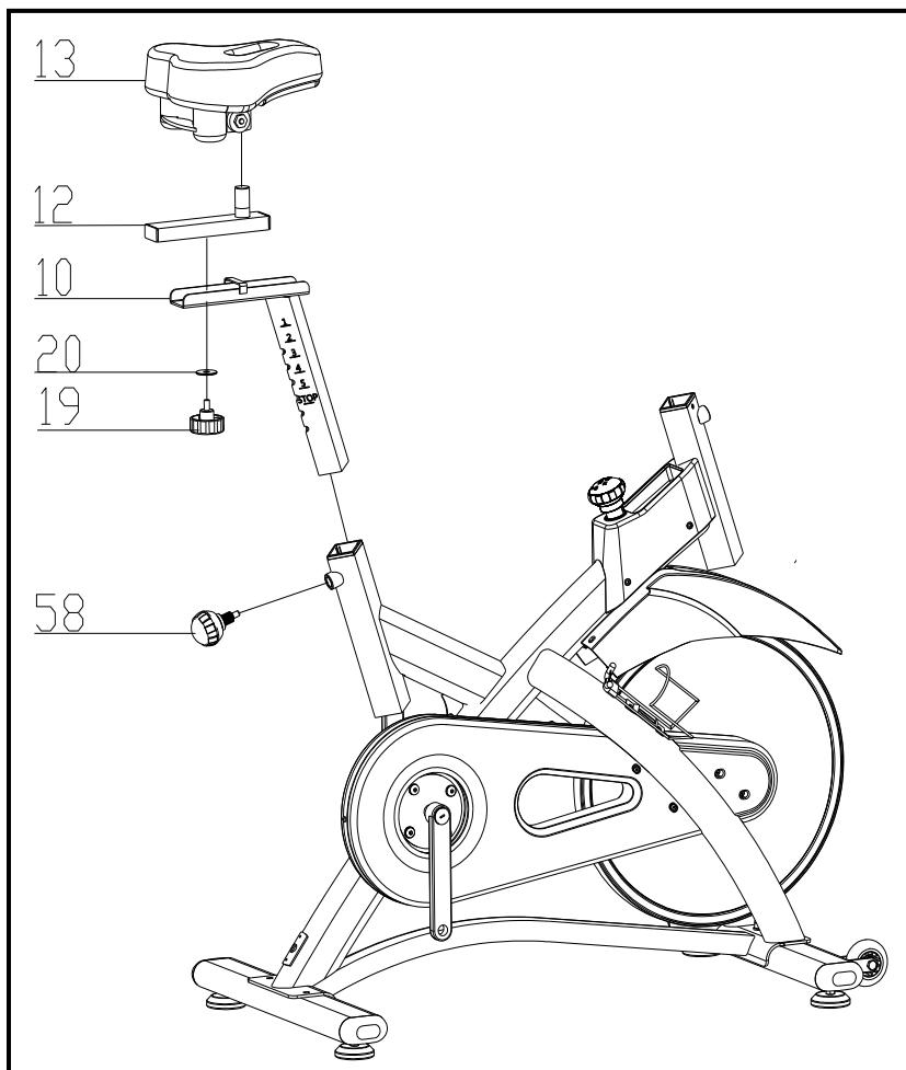
Установите вертикальную стойку сиденья (10) на основную раму (16). Затем установите направляющую сиденья (12) на вертикальную стойку (10), закрепите детали с помощью плоской шайбы 1 (20) и регулировочной ручки (19). Ослабьте регулировочную ручку (58) и вытяните назад, а затем отрегулируйте высоту сиденья. Вставьте регулировочную ручку на место и снова затяните.
