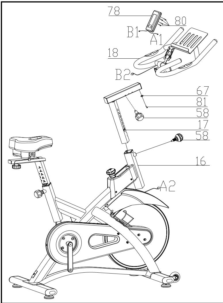
Установите стойку руля (17) на основную раму (16). Сначала нужно ослабить регулировочную ручку (7) и вытянуть назад, а затем отрегулировать высоту руля. Вставьте регулировочную ручку на место и снова затяните. С помощью ключа закрепите винт (81) и шайбу (67) на руле (18). Затем закрепите руль (18) с помощью болта (58).
