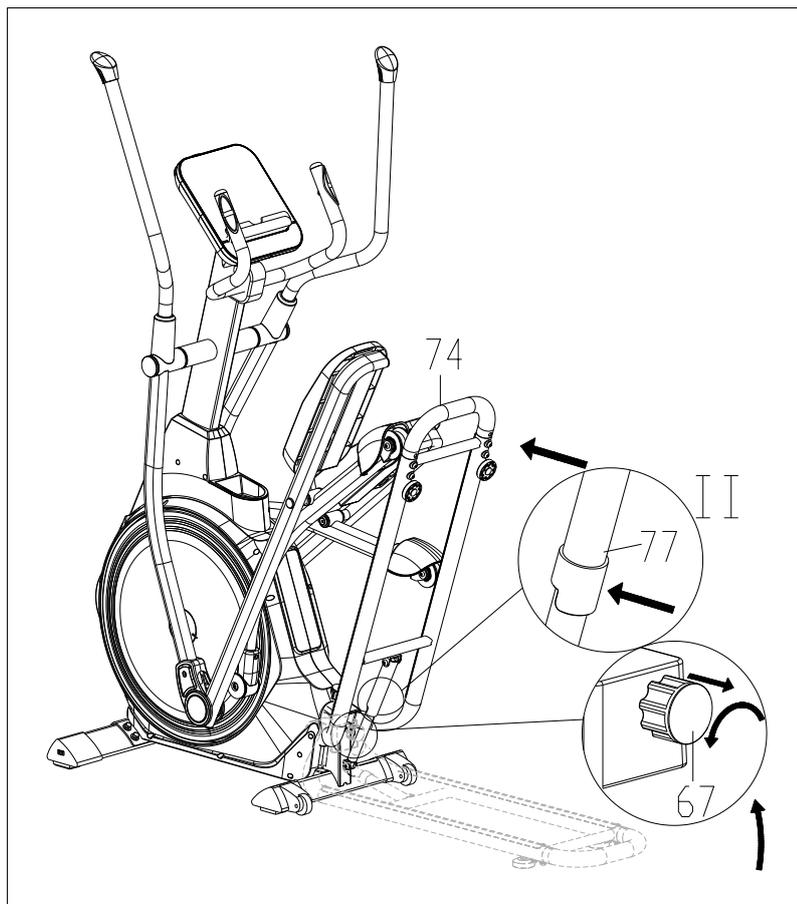
1. Если тренажер не используется, сложите направляющую, чтобы сэкономить место: Как показано на рисунке, слегка вытяните регулировочную ручку (67) и поверните против часовой стрелки примерно на 90 градусов, затем потяните за заднюю часть направляющей (74) и поднимите вверх до тех пор, пока газовая пружина (77) полностью не выдвинется и не встанет на место со щелчком. Убедитесь, что направляющая зафиксирована.
