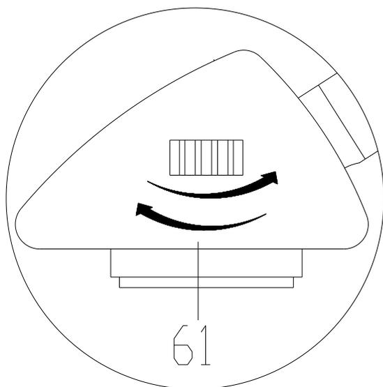
Если тренажер расположен на неровной поверхности, отрегулируйте компенсаторы пола с обеих сторон тренажера (61) в соответствии с рисунком.
