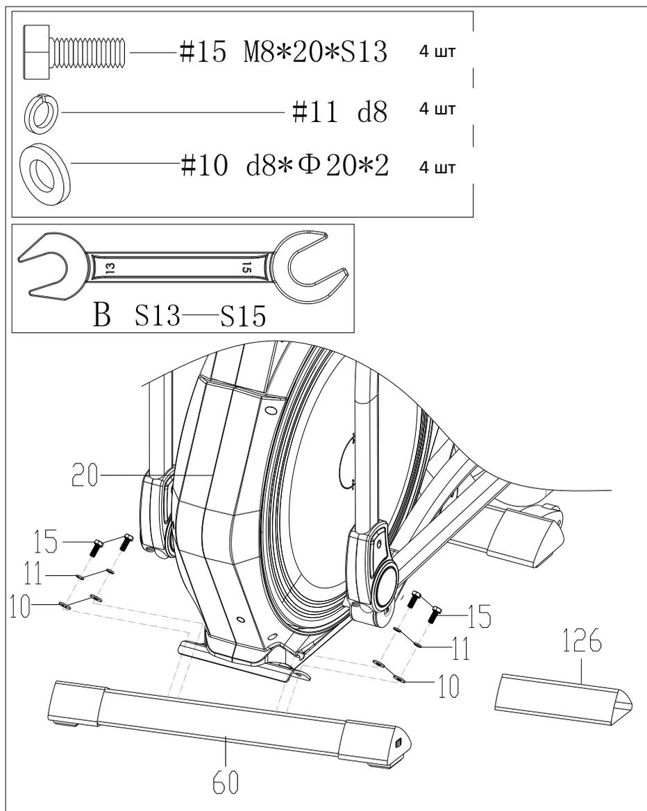
а. Выверните болты (15), пружинные шайбы (11) и саморезы (10) из пластикового стабилизатора (125) с помощью гаечного ключа (В). Снимите стабилизатор (125), а затем установите передний стабилизатор (60) на основную раму (20) и закрепите с помощью болтов (15), пружинных шайб (11), шайбы (10) и гаечного ключа (В).
