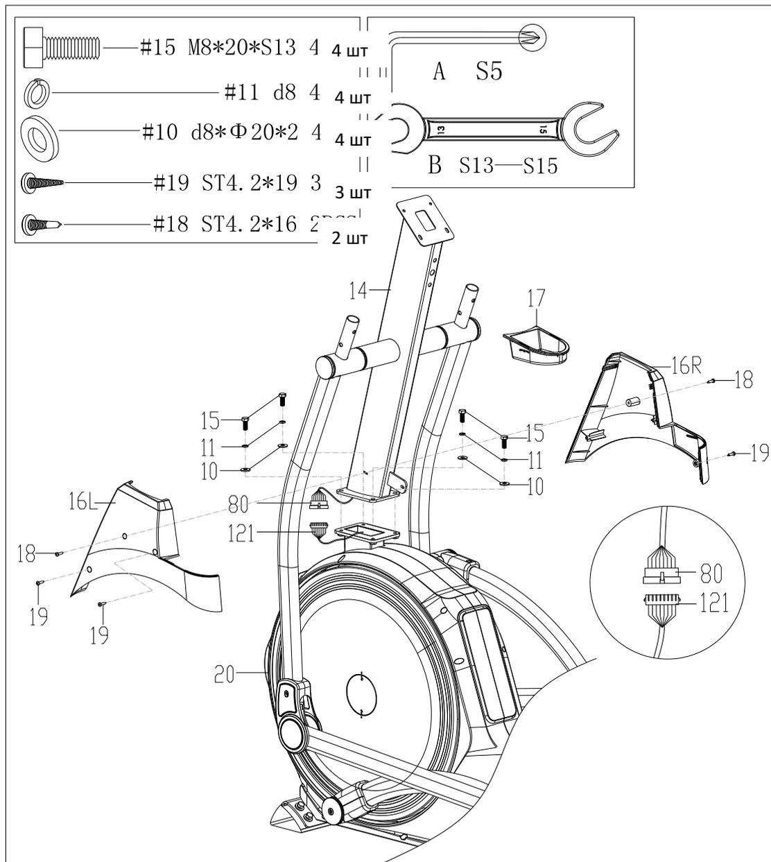
а. Подключите сигнальный кабель 1 (80), выходящий из стойки руля (14) с сигнальным кабелем 2 (121) основной рамы (20), затем поместите кабели внутрь основной рамы (20).
