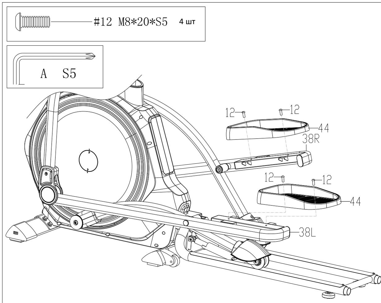
а. Выверните болты (12) из направляющих педалей (38L/R) с помощью гаечного ключа (А), а затем установите педали (44) на направляющие (38L/R) с помощью болтов (12) и гаечного ключа (А).
