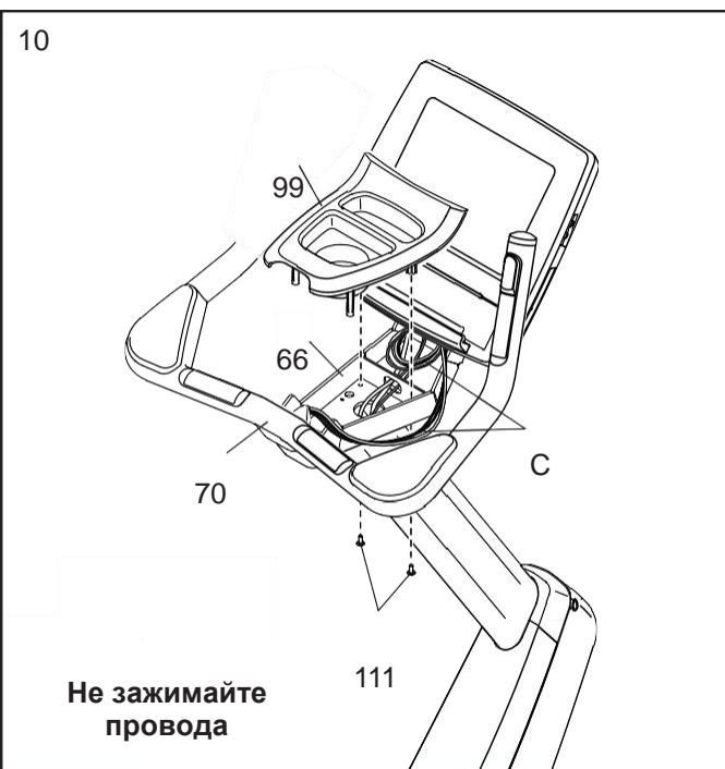
**11. Совет: Не зажимайте провода.** Закрепите заднюю крышку стойки (100) к лотку (99), расположенному на стойке (66) четырьмя винтами M5 x 12мм (111); **наживите винты, а затем затяните их.**
