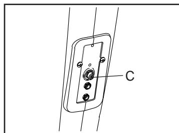
К тренажеру также можно подключить спутниковый приемник, видеомагнитофон или DVD-плеер. Подключите кабель CATV от коаксиального выхода вашего оборудования (обычно обозначенного TV OUT или RF OUT) к разъему кабеля на передней панели велотренажера.
