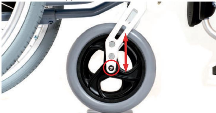
Передняя вилка быстросъемная. Для снятия передней вилки нажмите на фиксатор и снимите переднюю вилку. Установка производится в обратном порядке.
