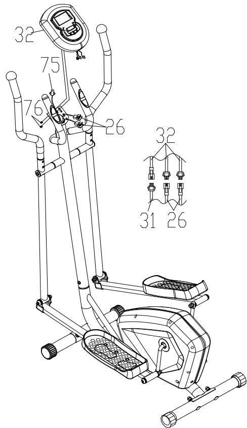
Соедините провода консоли (32) с проводами (32,26). Затем закрепите консоль (32) на стойке (2).
