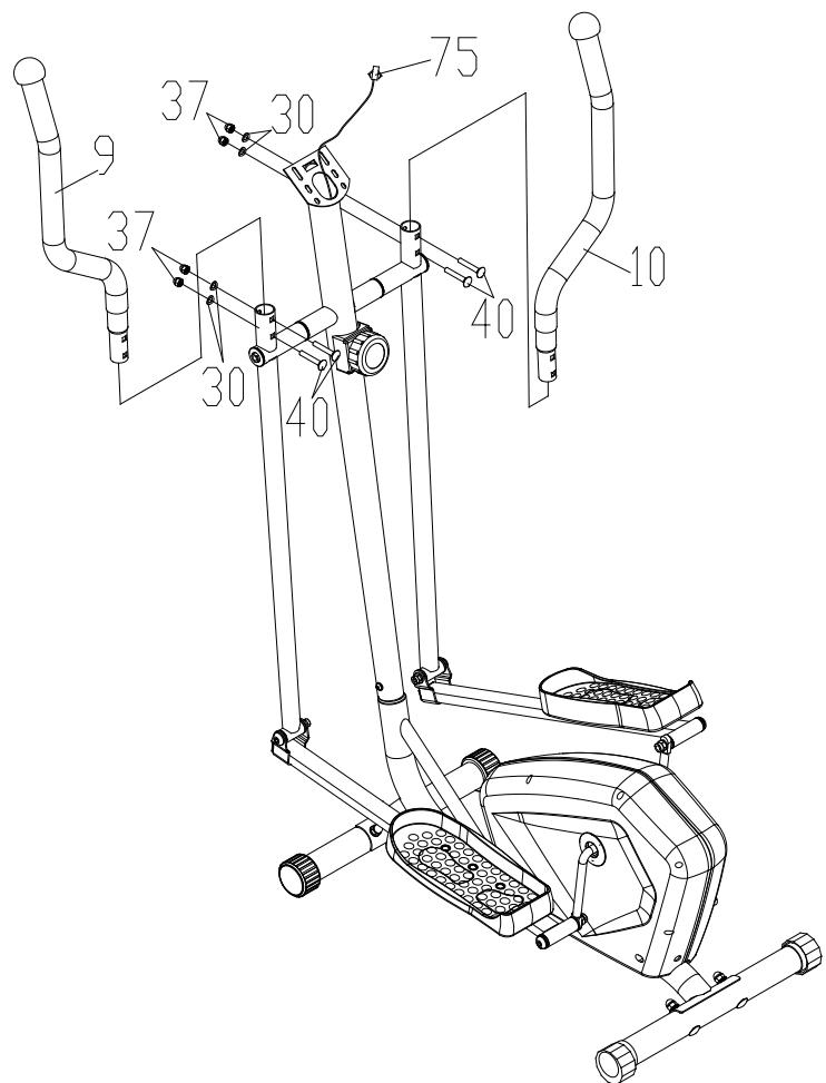
Закрепите нижний (9) и верхний (10) руль на основной раме (1) с помощью болтов (40), шайб (30) и гаек (37).
